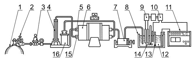
1 — баллон с кислородом (чистотой не менее 95 %) по ГОСТ 5583 (допускается использование кислорода из кислородопровода);
